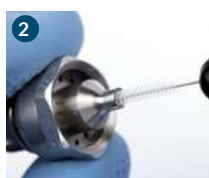
2 Limpar o orifício central do bico com escova especial.
