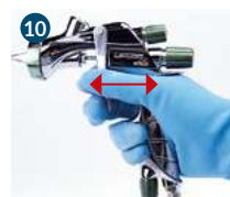
10 Verificar o funcionamento do gatilho e da agulha.
