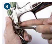
...e na válvula de ar por trás do gatilho.
