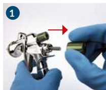
1 Retirar a porca de ajuste e a mola da agulha.
