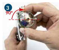
3 Montar o espalhador de ar e ajustar.
