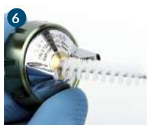
6 Limpar o orifício central do espalhador de ar.
